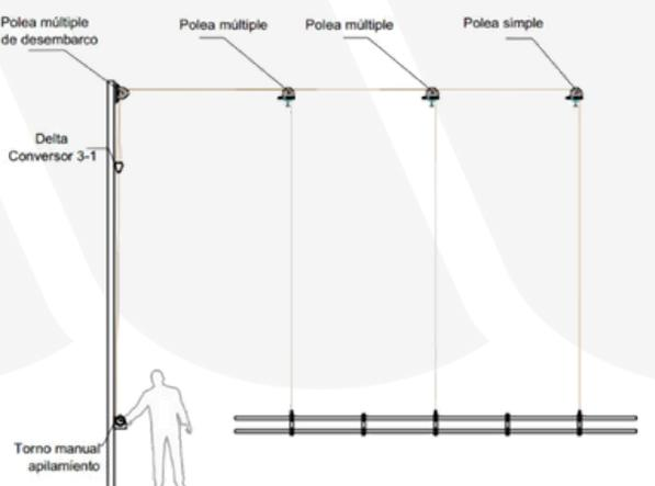
Diseño TTR - Apilamiento Montaje vertical
