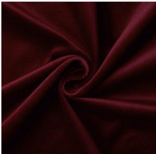
El tejido ha sido objeto de ensayo de acuerdo con las normas UNE-EN 1101:1996 (equivalente a EN 1101:1995) y UNE -EN 13772:2011 (equivalente a EN 13772:2011), quedando clasificada según norma UNE-EN 13773:2003 (equivalente en EN 13773:2003) como CLASE 1.
